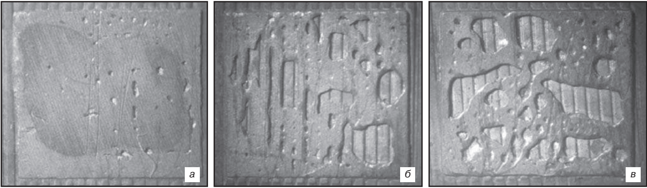
Рис. 4. Изображения ( \times 5,5 ) состояния припоя, полученные методом РЭМ, после стравливания кристаллов транзисторов КП723Г в зависимости от температурного режима посадки кристалла на теплопроводящее основание: а — T = 400\text{ }^\circ\text{C} , S_{\text{деф}} \approx (5\%)S_{\text{кр}} ; б — T = 440\text{ }^\circ\text{C} , S_{\text{деф}} \approx (30\%)S_{\text{кр}} ; в — T = 480\text{ }^\circ\text{C} , S_{\text{деф}} \approx (45\%)S_{\text{кр}}
