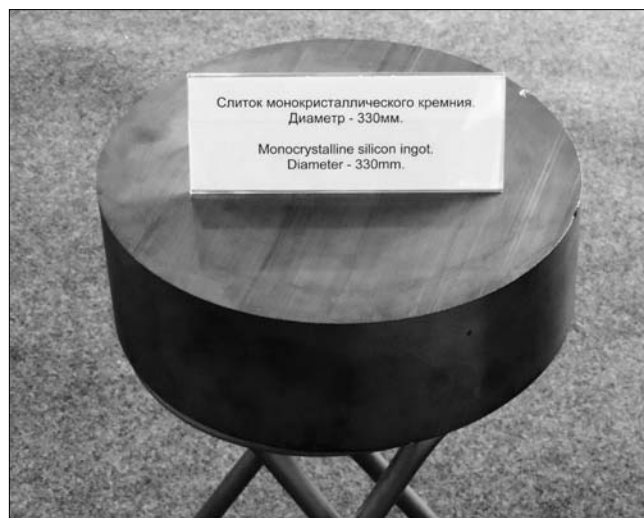
Рис. 14. Монокристалл кремния диаметром 300 мм (источник: «УКМ-Синтез»)
