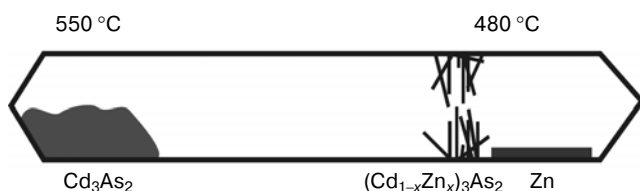
Рис. 1. Схема получения монокристаллов (\text{Cd}_{1-x}\text{Zn}_x)_3\text{As}_2 из паровой фазы
