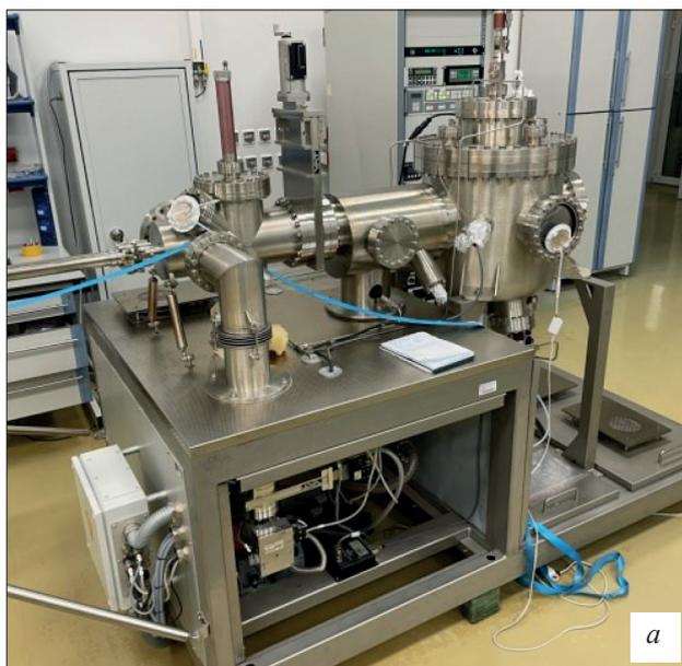
Рис. 1. Экспериментальный комплекс для синтеза наноструктур:
