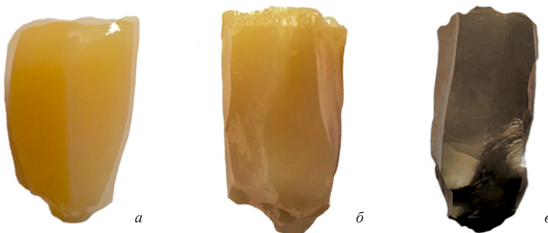
Рис. 1. Изображение кристаллов 3,7SmSZ до (а) и после термообработки кристаллов на воздухе (б) и в вакууме (в) Fig. 1. Appearance of 3,7SmSZ crystals (a) before and after (б) air and (в) vacuum annealing
