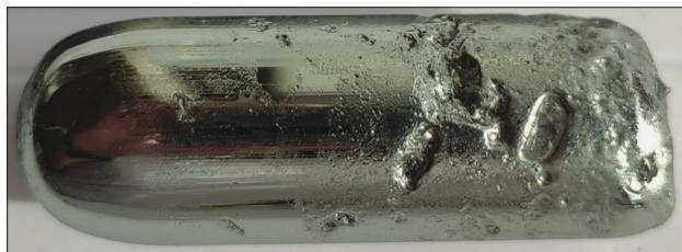
Рис. 5. Общий вид кристалла твердого раствора Ge—Si
