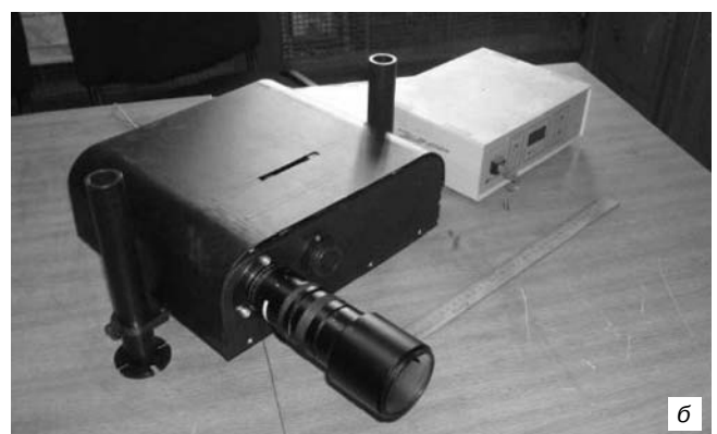
Рис. 2. Блок-схема экспериментальной установки (а) и общий вид цифрового голографического интерферометра (б)
