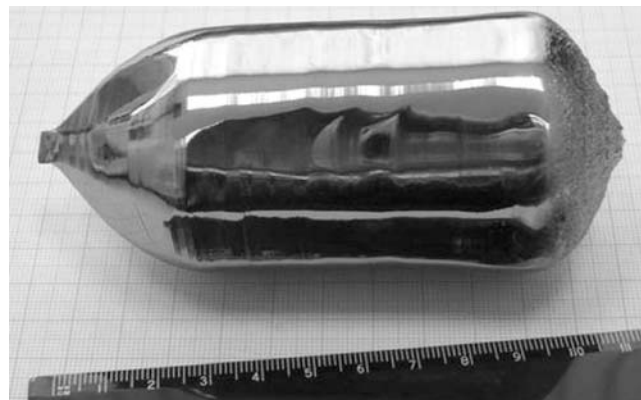
Рис. 1. Внешний вид нелегированного монокристалла антимонида индия диаметром 62—64 мм, выращенного в кристаллографическом направлении [100]
