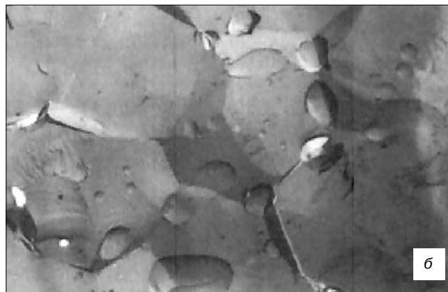
Рис. 5. Микрофотографии ферритов, полученных методом ДС с дошихтовкой ZnO: а — \times 10000 , d_c = 95\% , \sigma_{\text{и}} = 73 МПа, T = 1140 °С, t = 6 ч; б — \times 9000 , d_c = 97\% , \sigma_{\text{и}} = 114 МПа, T = 1140 °С, t = 6 ч + ПИВ (1030–6).
