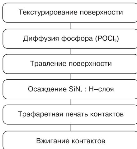
Рис. 1. Процесс производства солнечных элементов с архитектурой Al-BSF
