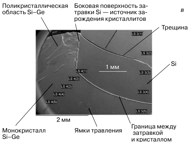
Рис. 3. Кристалл Si—Ge (а), EDX линейное сканирование (серая горизонтальная линия) вдоль выросшего кристалла (б) и IC—микрофотография области вблизи затравки Si (в). Черная вертикальная линия соответствует измерениям Ge поперек кристалла для z = 1,5 мм, точки 1 на краю и 3 на оси кристалла принадлежат одной и той же полосе роста; LS — точки в местах замеров
