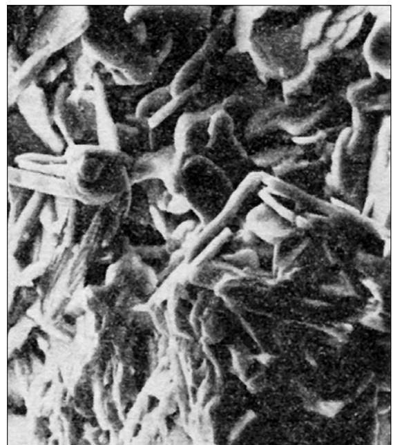
Рис. 2. Микроструктура керамики  $\text{Bi}_7\text{Ti}_{4,5}\text{W}_{0,5}\text{O}_{21}$  ( $\times 2400$ )
