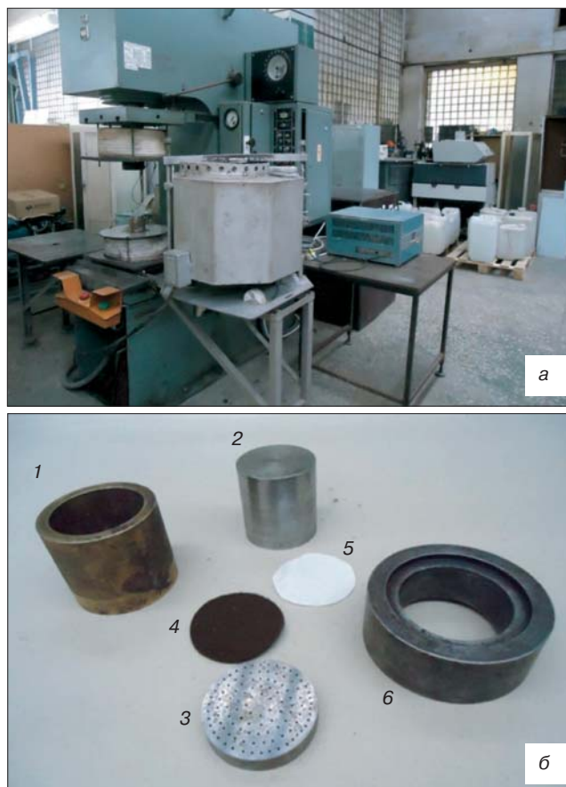
Рис. 2. Внешний вид пресса (а) и пресс-формы (б) для получения сырых заготовок анизотропных гексаферритов: б: 1 — матрица; 2 — верхний пуансон; 3 — нижний пуансон; 4 — фетровый фильтр; 5 — фильтр из х/б бязи; 6 — распрессовочное кольцо
