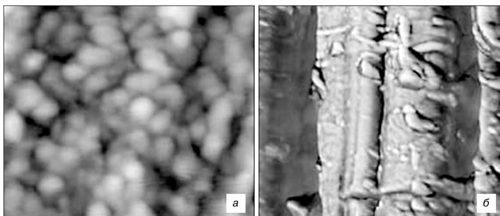
Рис. 3. АСМ-изображение разных участков поверхности АУВ, модифицированных гидроксидом никеля [15]
