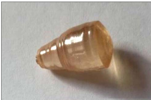
Рис. 1. Кристалл \text{LiNb}_{0,5}\text{Ta}_{0,5}\text{O}_3 , выращенный вдоль полярной оси Z
