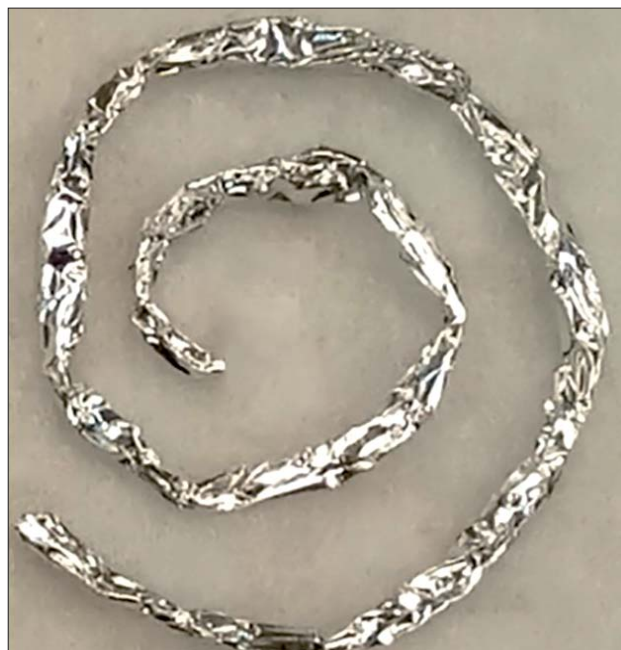
Рис. 3. Внешний вид одного из спиралевидных элементов, включенных в объем образцов I типа
