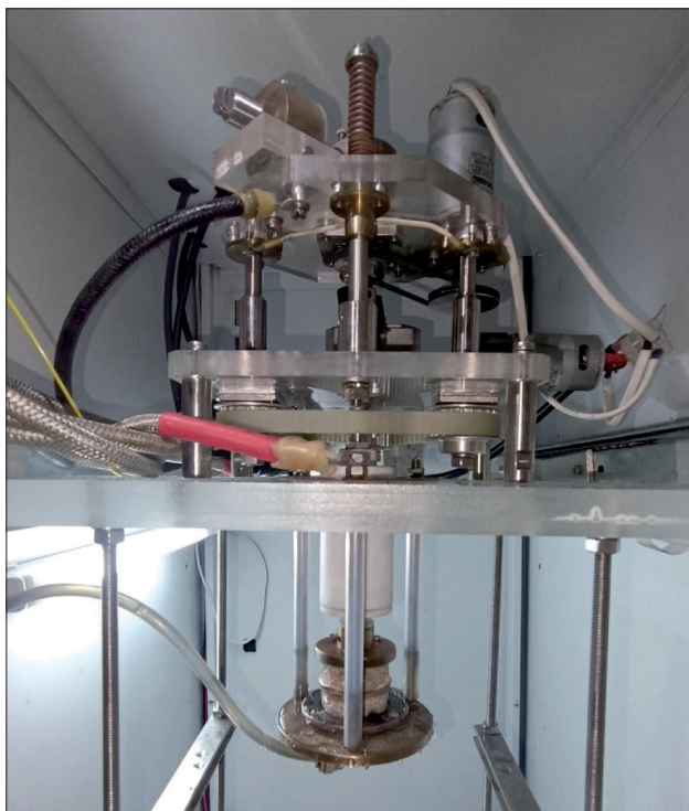
Рис. 13. Внешний вид электродного узла электроимпульсной установки формирования наночастиц в жидкой среде
