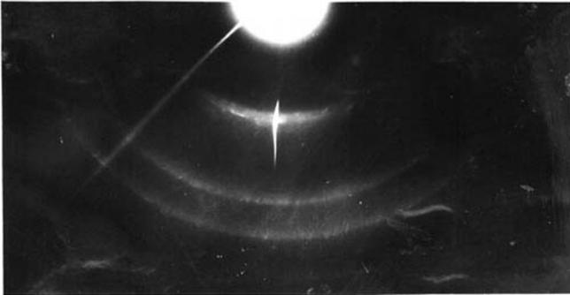
Рис. 2. Электронограмма отражения от пленки карбида кремния, полученной при  $T = 1200\text{ }^{\circ}\text{C}$  и  $C_2 = 0,76\text{ г/л}$
